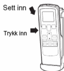
2. Sett i fjernkontrollen
