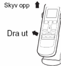
3. Ta ut fjernkontrollen
